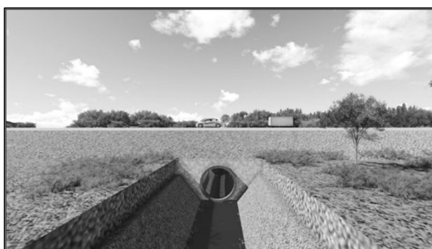
รูปที่ 5.8-6 รูปแบบท่อกลมเบื้องต้น
