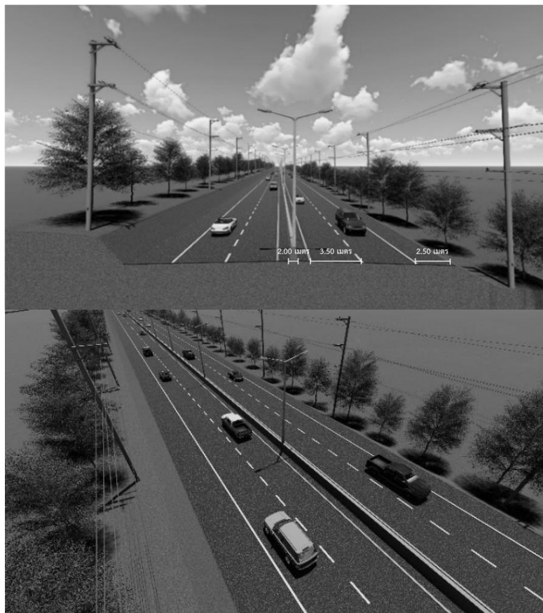
รูปที่ 5.2-4 รูปแบบที่ 3 ทางหลวงขนาด 4 ช่องจราจร เกาะกลางแบบกำแพงคอนกรีต (Barrier Median)
